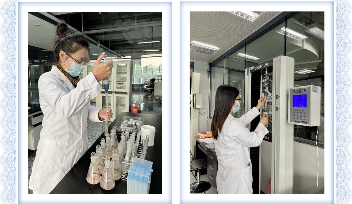
化驗員在進行pH、甲醛測試，及彈性、強力測試
